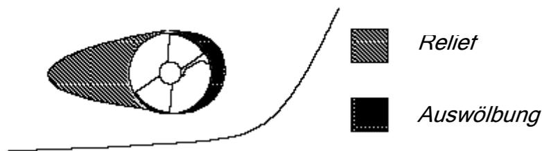
Es werden hierdurch Wasserturbulenzen in der Rohröffnung vermindert. Zur weiteren Strömungsverbesserung könnte für das abfließende Wasser nach hinten eine gewisse Hohleinkerbung (Relief) in den Rumpf erfolgen. Das ist jedoch meist nur möglich, wenn der Einbau bereits mit der Rumpffertigung erfolgt.
